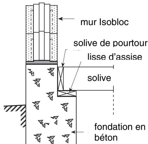
**Figure 2. « Isobloc » sur fondation en béton**
