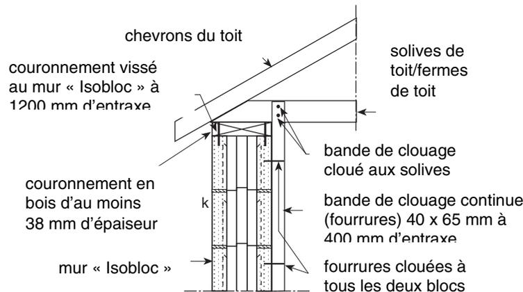
**Figure 6. Fourrures utilisées comme point de fixation au toit**
