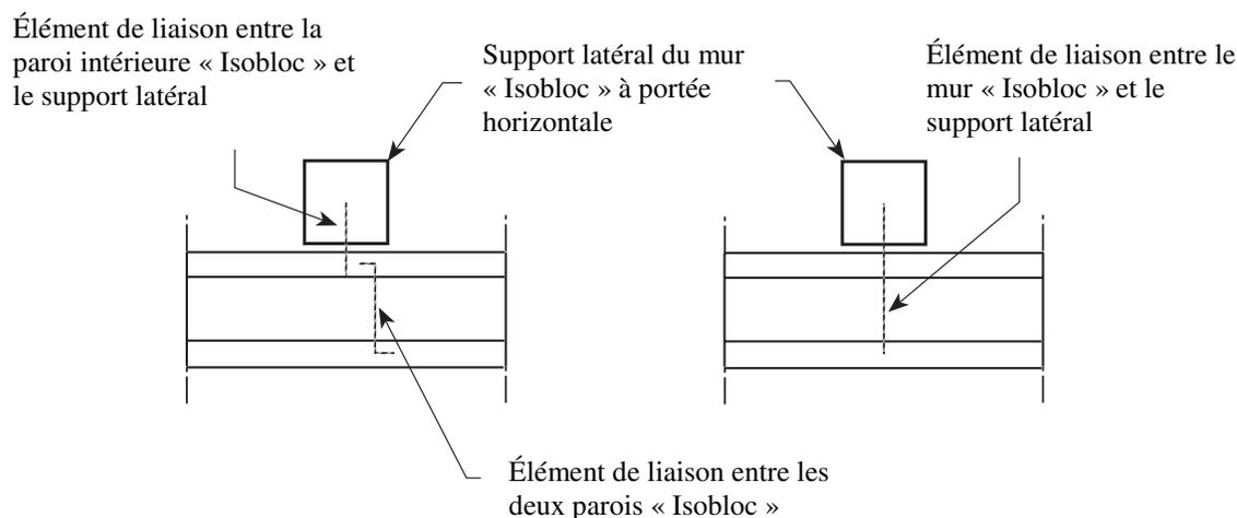
**Figure 5. Systèmes de liaisonnement « Isobloc » aux supports latéraux**
